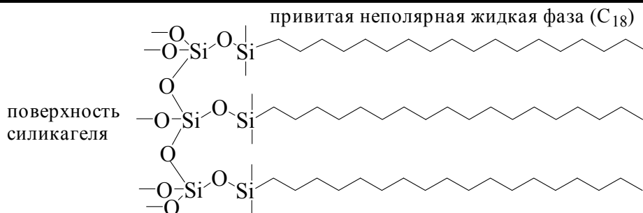
Рис. 24.1. Кремнезём с привитыми октадецильными группами
