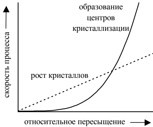
Рис. 11.2. Зависимость скоростей процессов образования первичных центров кристаллизации и роста кристаллов от величины ОП
