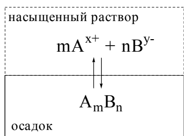
Рис. 6.1. Равновесие в системе «осадок - насыщенный раствор малорастворимого сильного электролита»
