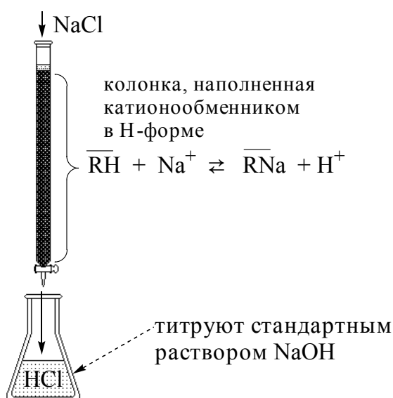
Рис. 24.7. Определение NaCl методом ионообменной хроматографии
